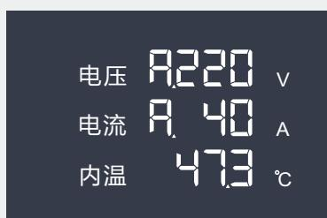
A相电压220V A相电流40A 内温47.3°C
